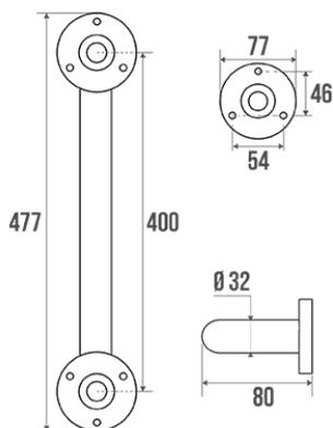
Tube inox 304 poli brillant Ø 32 mm. Platines et cache-fixations en inox poli brillant.
