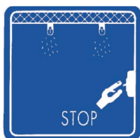
- 1 - Déconnecter les détecteurs de fumée
